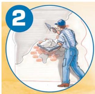
A questo trattamento deve seguire dopo circa 12 ore l'applicazione, a mano oppure a macchina intonacatrice e in spessori di 5/6 mm, di **TD 13 Dry Rin** per regolarizzare il supporto e creare una superficie di aderenza per la successiva applicazione di **TD 13 Dry Soft** deumidificante macroporoso.
